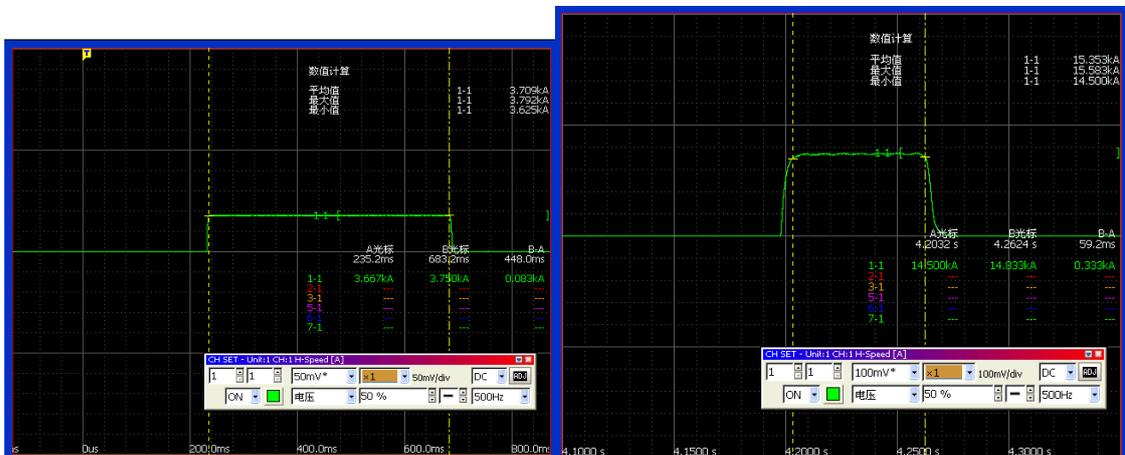
圖 5 實測的直流短路校正電流波形
