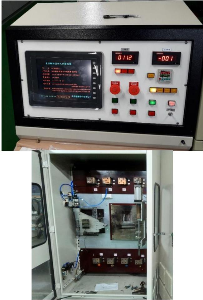
圖8 直流電氣耐久性試驗設備控制機台與樣品箱
