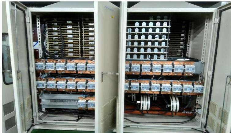
圖9 直流電氣耐久性試驗設備RL負載箱
