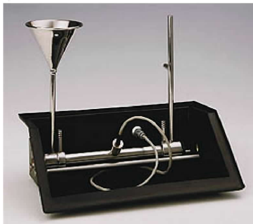
圖 3 附有溫度感應器之樣品槽
