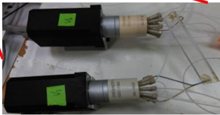
圖四十一：電子級氨水中無機不純物濃度分析系統。
