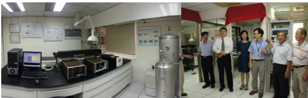
(b) 改造後（空間可同時設置兩套臭氧標準參考光度計，並增設一套加裝純
